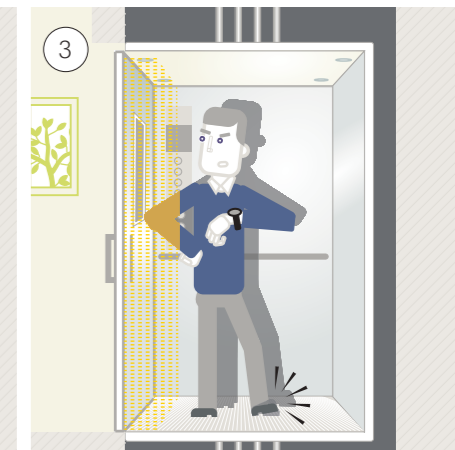
Cabinas sem porta de cabina
