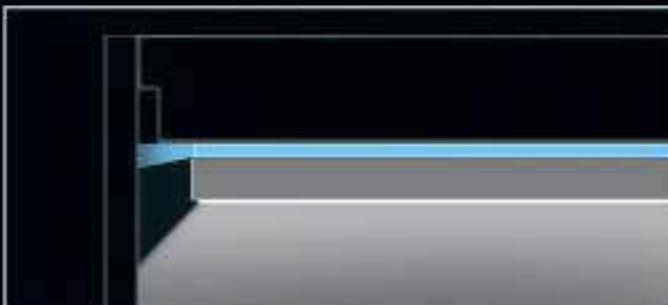
Corte vertical do teto luminoso LD8-LED-RGB. Esquema de funcionamento da iluminação direta. LED branco neutro, controlo de luz LED-RGB.
