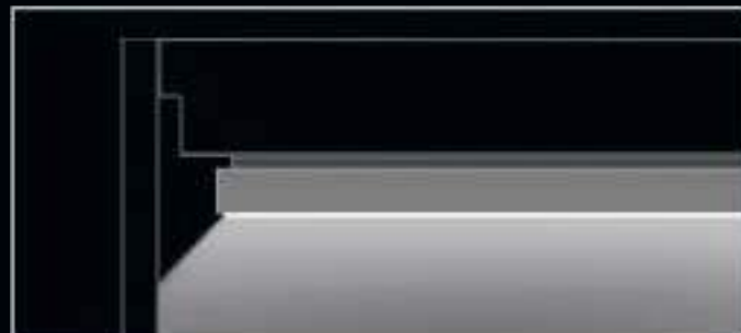
Secção vertical teto falso em vidro LD8-LED. Esquema funcional iluminação direta. LED branco neutro.
