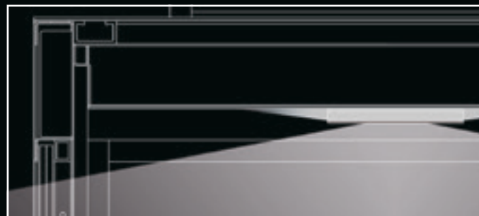
Secção vertical Iluminação de teto LD7-LED-RGB Esquema funcional iluminação direta e indireta LED branco neutro
