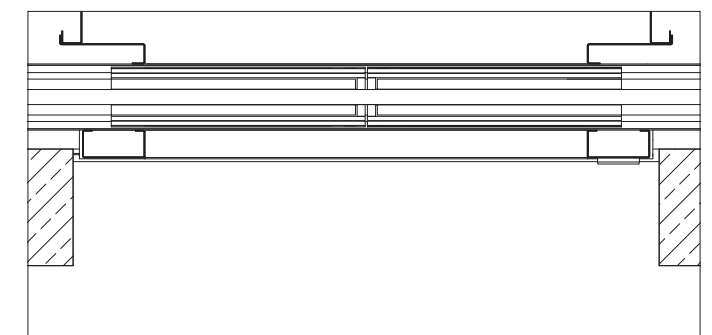
Secção horizontal das portas de cabina e de patamar com aros / Remates de parede T1.
