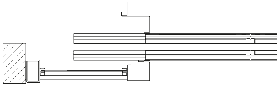
Secção horizontal das portas da cabina e de patamar com portal em vidro P7-G
